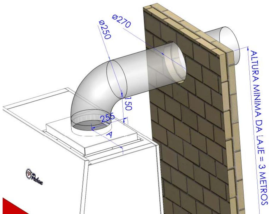
*Figura 8 – Esquema de dutagem para os tamanhos T2,5 a 6*
