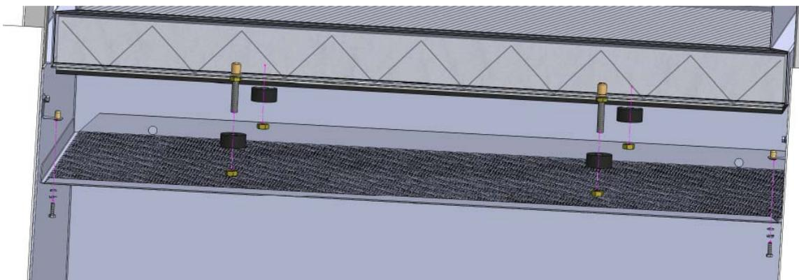
*Figura 13 – Representação para troca de filtros no modelo vertical*
