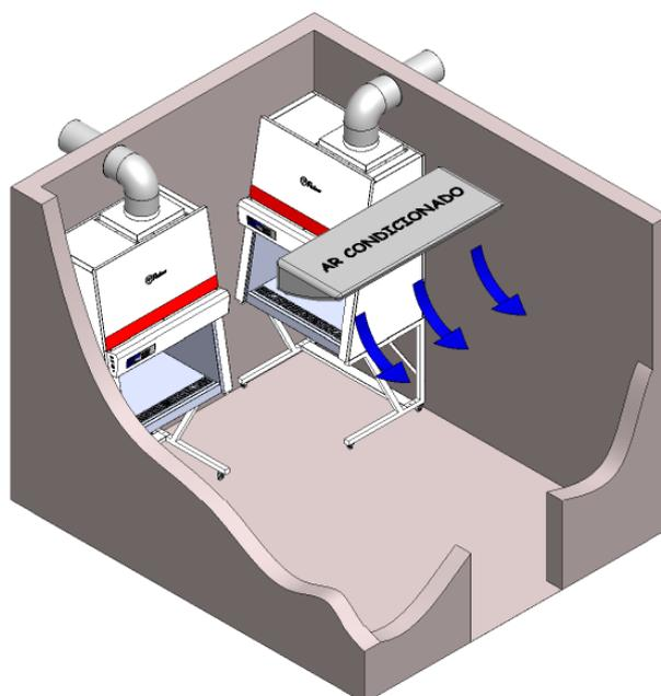
Figura 6 – Posicionamento correto do equipamento em uma sala, evitando o fluxo do ar condicionado (setas azuis).
