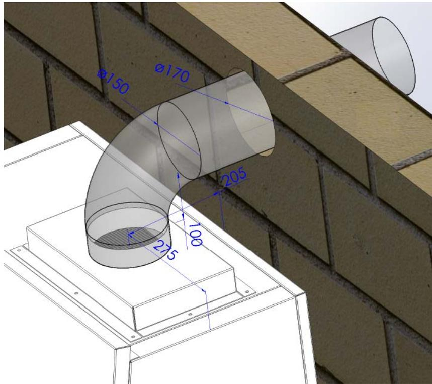
*Figura 7 – Esquema de dutagem para o equipamento T2*
