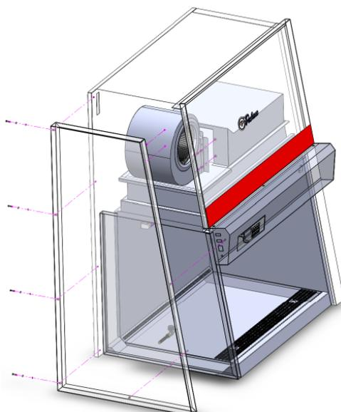
Figura 14 – Representação para troca de motor
