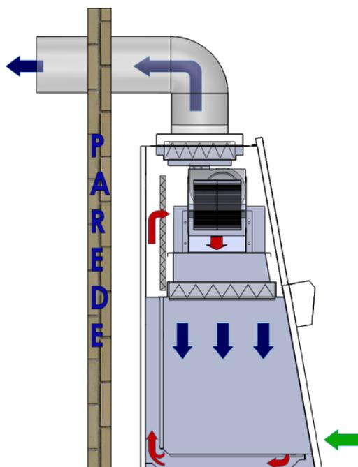
*Figura 2 – Visão lateral em corte do fluxo de ar na linha 700.*
