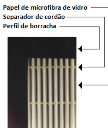
Figura 3 – Detalhes da estrutura do filtro HEPA
