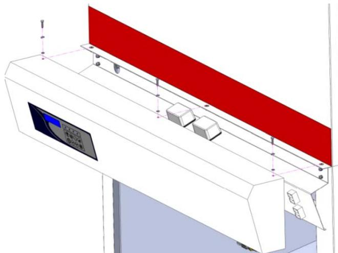
*Figura 16 – Acesso dos reatores das lâmpadas fluorescentes*
